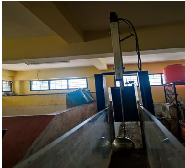
Gambar 3. Peralatan Pengendali Buka Tutup Pintu Air skala laboratorium
