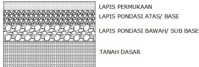
Gambar 2. 1 Susunan Lapisan Perkerasan Lentur
